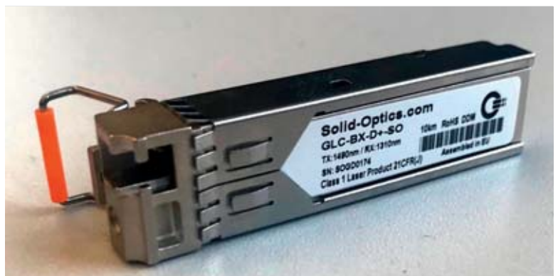
Bild 1: SFP-Transceiver für bidirektionale Übertragung im Ethernet Standard 1000BASE-BX10
