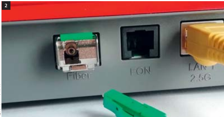
Bild 2: Steckbarer SFP-Transceiver in der Fritzbox. Die Verbindung zum Glasfaser-Zugangsnetz wird mit einem LC-8°-Steckverbinder hergestellt.
