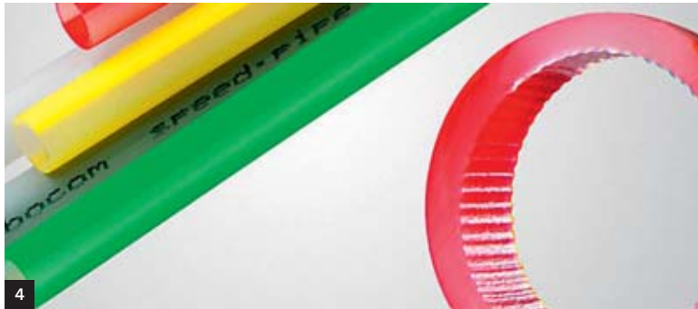
Bild 4: Transparente Mikroröhren mit Farbstreifen – die Innenriefung sorgt dafür, dass große Einblaslängen erreicht werden
