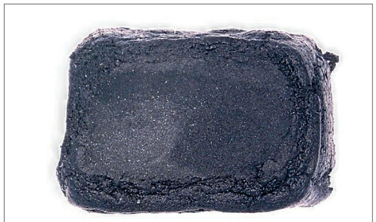
Bild 3: EPDM-Werkstoff für den Lebensmitteleinsatz, der durch ungeeignete Füllstoffe bei der Dampfsterilisation angequollen und im Randbereich sogar depolymerisiert wurde.
