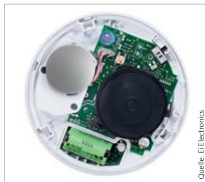
Bild 3: Blick in einen Rauchwarnmelder mit Rauchkammer, Zehn-Jahres-Batterie, Piezohorn und Platine
