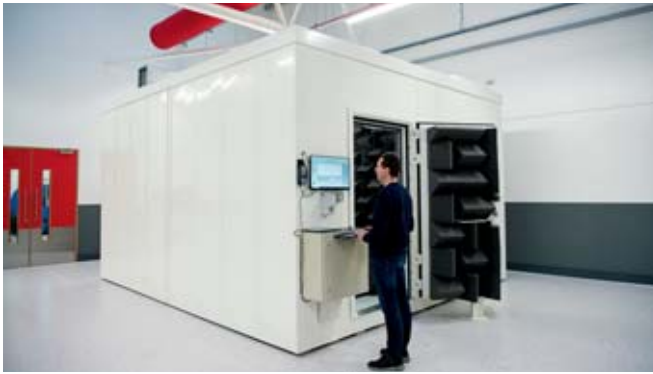
Bild 2: In der reflexionsfreien Schallkammer werden die akustischen Eigenschaften der Warmmelder vermessen
