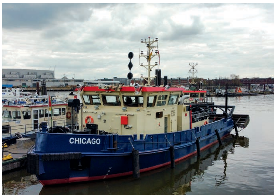
Bild 1: Das Planierschiff Chicago verfügt über einen modernen Hybridantrieb, der aus zwei Dieselmotoren sowie zwei Elektromotoren von BEN Buchele besteht – letztere unterstützen die emissionsarmen Fahrten innerhalb des Hafengebiets
