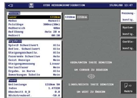
Bild 5: Messparameter und Einstellmenü beim MTS 5100
