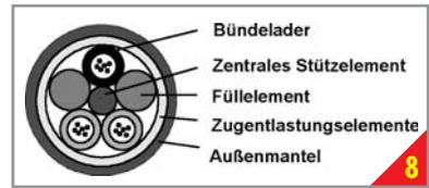
LWL-Kabel mit 3 Bündeladern mit jeweils 6 LWL-Fasern, zentralem Stützelement, 2 Füllelementen und nichtmetallischer Zugentlastung aus Aramid
