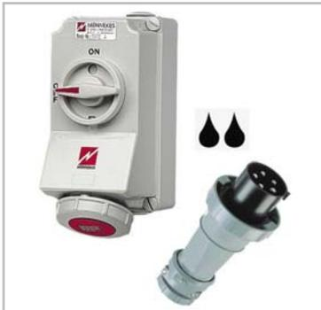
*Bild 2: CEE-Steckvorrichtungen in Schutzart IP 67 sind auch im gesteckten Zustand wasser- und staubdicht – die »Duo«-Steckdose bietet zusätzliche Sicherheit: Stecker kann nur in Aus-Stellung gesteckt und gezogen werden; Ein-Stellung nur möglich bei gestecktem Stecker*
