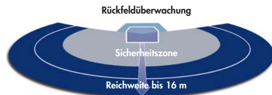
**Bild 2:** Das Betreten der Sicherheitszone signalisiert der Wächter durch eine rote Warnleuchte sowie über einen separaten Ausgang
