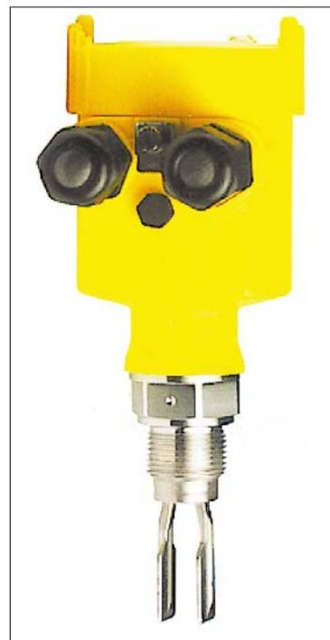
**Bild 4:** Der Grenzstandwächter von Vega arbeitet wie eine Stimmgabel und unabhängig vom Medium
