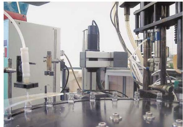
**Bild 3:** Die Ultraschallsensoren von Welotec erfassen dank der kleinen Abstrahlwinkel auch Füllstände in Flaschen
