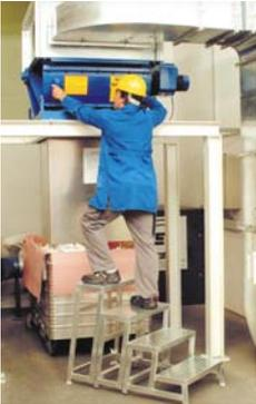
funktioniert werden. In max. fünfstufiger Ausführung ist die oberste Trittlfläche 1 m hoch.
