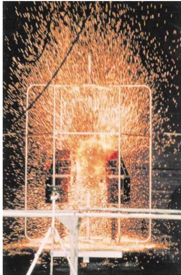
**Bild 2:** Mit einer Spannung von 3 kV und Stromstärken von bis zu 13 kA werden reale Störlichtbogen-Bedingungen erreicht
