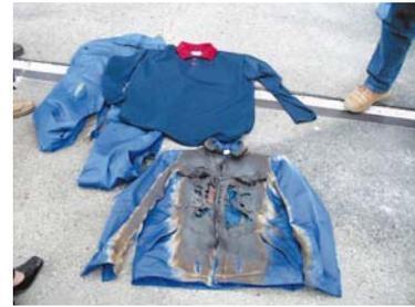
**Bild 3:** Test am »Arc-Man« bestanden: Nur die Außenschicht der mehrlagigen Schutzausrüstung aus Nomex zeigt Einwirkungen des Störlichtbogens, die Innenschicht ist unversehrt
