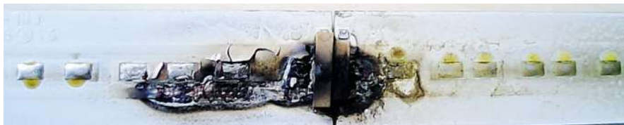
Bild 7: Zwei lineare Platinen, bei denen am Verbinder ein Brand auf Grund hoher Spannungen eingetreten ist
