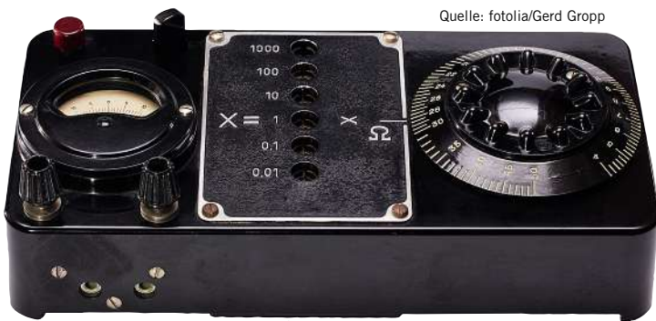
Bild 40: Museales Stück – dennoch lieferten Messbrücken dieser Art z.T. sehr genaue Ergebnisse
