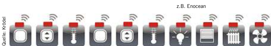
Bild 5: Dezentrale Variante mit Funk/Powerline
