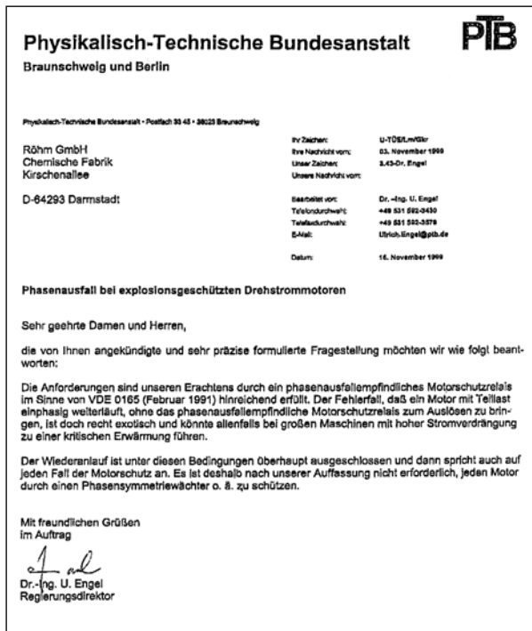
Bild 5: Die PTB betrachtet das phasenausfallempfindliche Motorschutzrelais als normgerechten und ausreichenden Schutz auch im Ex-Bereich
