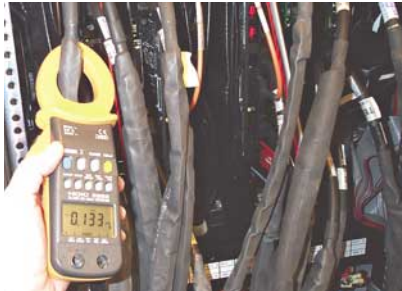
Bild 3: Auf jedem geschirmten Datenkabel in diesem Plattenschrank flossen 100 ... 300 mA eff und bis zu 1,5 A Spitze-Spitze
