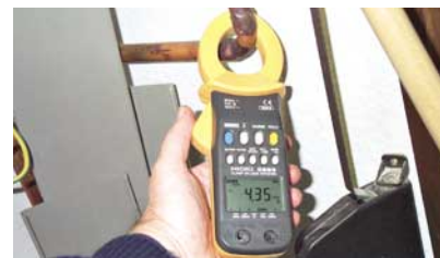
Bild 6: Über diese Gasleitung flossen über 4 A_{\text{eff}} und 16 A_{\text{Spitze-Spitze}}
