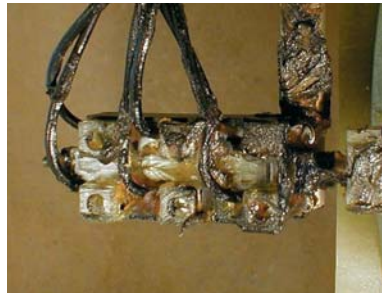
Bild 10: Betätigter verschmutzter Grenztaster in der Anlage
