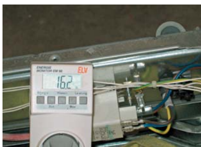
Bild 4: Messung der Scheinleistung
