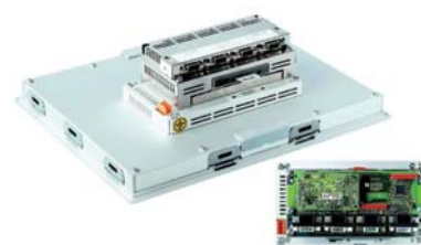
Bild 1: Ein embedded Touchpanel von hinten; die Steckplätze ermöglichen die Erweiterung mit Hardwaremodulen, die Schnittstellen lassen sich frei konfigurieren, die Software liegt auf einem Wechselmedium; eine Austauschbarkeit und Wiederverwendbarkeit ist somit gewährleistet
