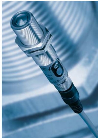
Bild 1: Laserlichtschranke mit Fokusverstellung; damit ausgerüstete Laser-Einweglichtschranken erkennen auch über ihre Maximaldistanz von ca. 50 m noch sicher Objekte von nur 2 mm Größe
