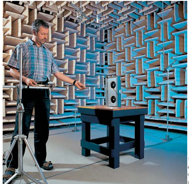
Bild 2: Der Messraum mit schallschluckenden Wänden
