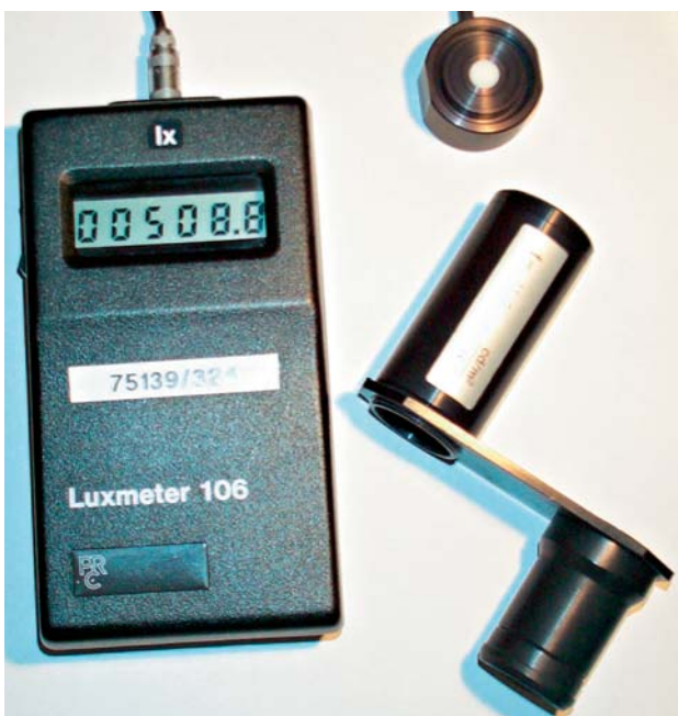
Bild 3: Luxmeter Typ-Klasse B mit Aufsatz zur Ermittlung der Leuchtdichte
