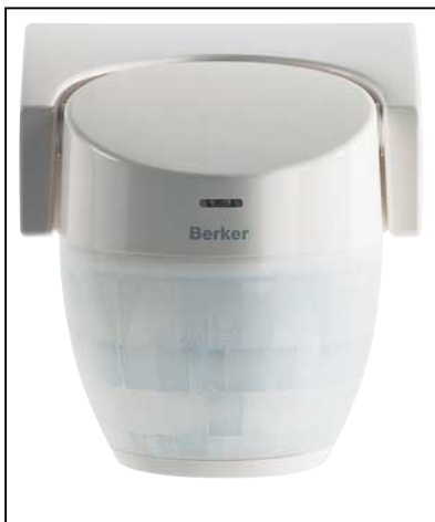
Bild 2: Der Wächter Berker Control bietet einen Erfassungswinkel von 220°. Er erfasst Bewegungen noch in 16m Abstand auf einer Breite von 20m
