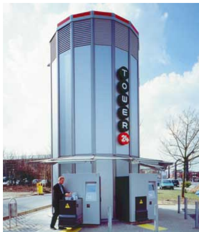
Bild 1: Eine dezentrale Abholstelle »Tower 24« im Technologiezentrum Dortmund; sie bündelt Warenströme bis in eine gewisse örtliche Nähe zum Kunden
