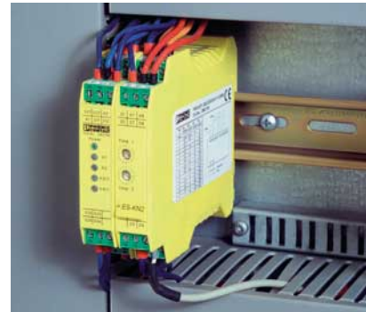
Bild 3: Sicherheitsrelais-Kombination mit steckbaren sowie kodierten Anschlussklemmen
