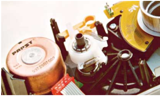
Bild 4: Die Rotorglocke des Motors dient gleichzeitig als Bestandteil einer patentierten Bremsmechanik, um Abrieb und Korrosion zu vermeiden; ist sie vollständig verkupfert
