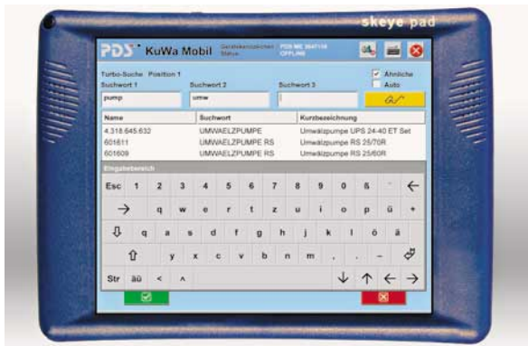
Bild 2: Der Taschencomputer hat keine externe Tastatur, sondern man gibt die Daten durch Berühren des Bildschirms ein; für die Texteingabe blendet sich eine Tastatur ein, die man auch mit einem Stift bedienen kann (das Beispiel zeigt die Suche nach einer Pumpe/Umwälzpumpe)
