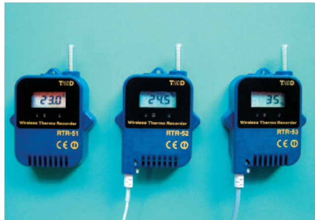
Bild 2: Die Funkdatenlogger des japanischen Herstellers T&D lassen sich per Funk auslesen. Die Anwendungsmöglichkeiten sind vielfältig und reichen von der Überwachung des Raumklimas in Gebäuden bis zur Messung der Temperatur bei Kühltransporten
