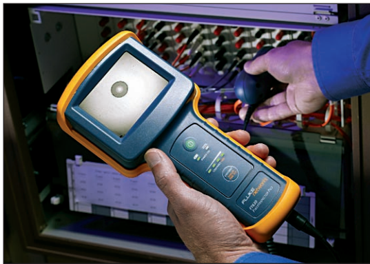
Bild 3: Endflächen sollten sowohl während als auch nach der Konfektionierung inspiziert werden
