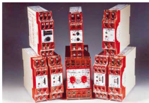
Bild 1: Die Funktionspalette der Zeitrelais umfasst anzug- oder abfallverzögerte Geräte über Taktgeber bis hin zu multifunktionalen Zeitrelais mit einstellbaren Funktionen oder speziellen Stern-Dreieck-Relais
