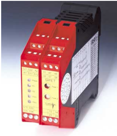
Bild 3: Zeitrelais kommen auch in der Sicherheitstechnik zum Einsatz; das controllergesteuerte Gerät mit zwei einstellbaren, zeitverzögerten Kontakten erfüllt die Anforderungen der Sicherheitskategorie 4 nach EN 954-1
