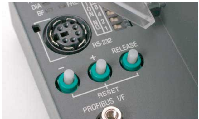
Bild 3: Kopfstation mit Profibus-DP-Anschluss; durch An- und Abwahl der zugeordneten E/A-Baugruppen kann man die Baugruppen unter Spannung wechseln (Hot Swap)
