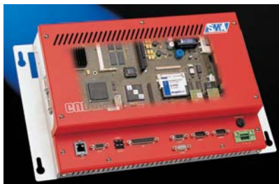
Enduro VGA von SMA, ein robuster Kompaktrechner mit Grafikschnittstelle
