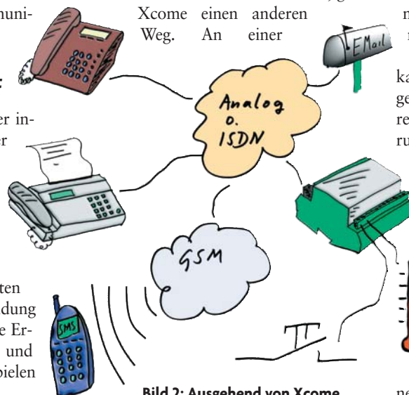
Bild 2: Ausgehend von Xcome, welche die Überwachung der Maschine oder Anlage übernimmt, können die Informationen über SMS, Fax, E-Mail oder Sprachnachricht den Adressaten erreichen
