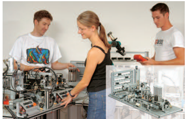
Bild 3: Mehrere Funktionsbaugruppen/Teilprojekte kann man im Rahmen einer Gruppenarbeit zu einer komplexen Anlage zusammenführen
