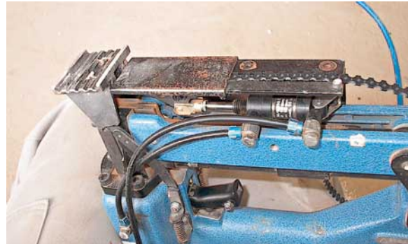
Bild 2: Ein Stegleitungs-nagler treibt die Nägel exakt zwischen den Adern ein; die Führungsmatrix fixiert die Stegleitung und schont deren empfindliche Gummiumhüllung
