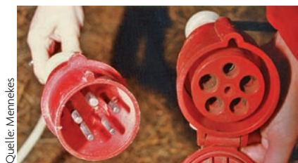
Bild 14: Beim Einsatz in landwirtschaftlichen Betrieben lässt es sich gar nicht vermeiden, dass sich Schmutzablagerungen bilden. Gute Steckvorrichtungen tragen dies auch klaglos. Allerdings sollten die Kontakte regelmäßig gereinigt werden, um die Übergangswiderstände möglichst gering zu halten und somit unzulässig hohe Erwärmung der Kontakte zu vermeiden
