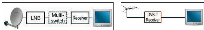
Bild 1: Blockschaltbilder: Sat-Empfangsanlage (links), DVB-T Empfangsanlage (rechts)
