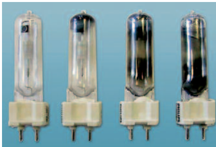
Bild 1: Verschiedene Stadien der Schwärzung des äußeren Hüllkolbens von CDM-T Lampen infolge gealterter Keramikbrenner (Undichtigkeiten)
