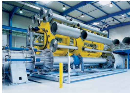
Bild 1: Modul FCP 7.2 für DN 250...2000 mit dem Revolverteil für die unterschiedlichen Nennweiten; die geeigneten Anpasstücke werden hydraulisch eingespannt, um den Prüfling möglichst wenig mechanisch zu belasten
