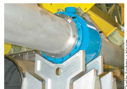
Bild 2: Radiale Positionierung des Prüflings auf hydraulisch verstellbaren Prismen; die Anpassung der Messgeräte an die Anlage erfolgt über genormte Adapter
