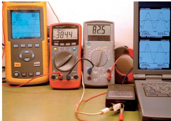
Bild 1: Eingangsstrom eines Laptop-Netzteils, gemessen mit verschiedenen Messgeräten, einmal ohne ...
