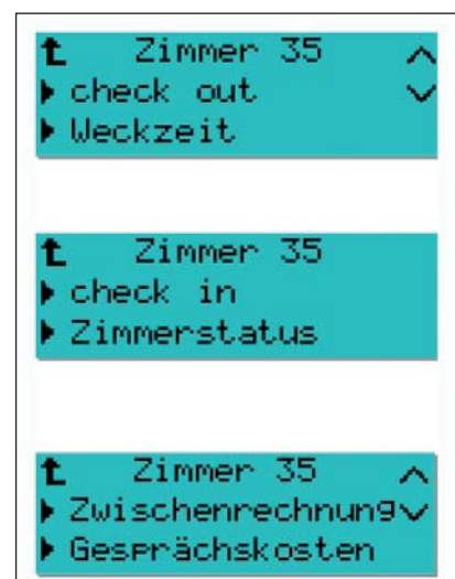
Bild 2: Verschiedene Display-Anzeigen am Telefon: Einfaches Check-in /Check-out, Abfrage des Zimmerstatus und zentrale Einstellungen für Zimmerapparate
