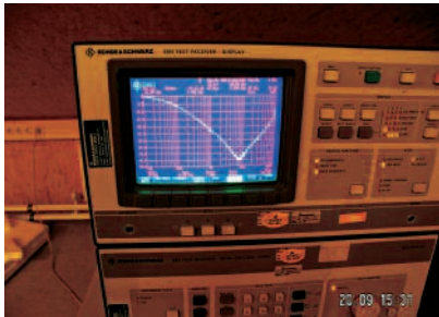
Bild 7: Messaufbau der Einfügedämpfungsmessung
