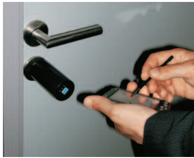
Bild 3: Eine Änderung der Schließberechtigungen, z. B. nach einem Schlüsselverlust, wird vom System auf einen Palm-Top überspielt; über einen Adapter wird der betreffende Schließzylinder über die Berechtigungsänderung informiert
