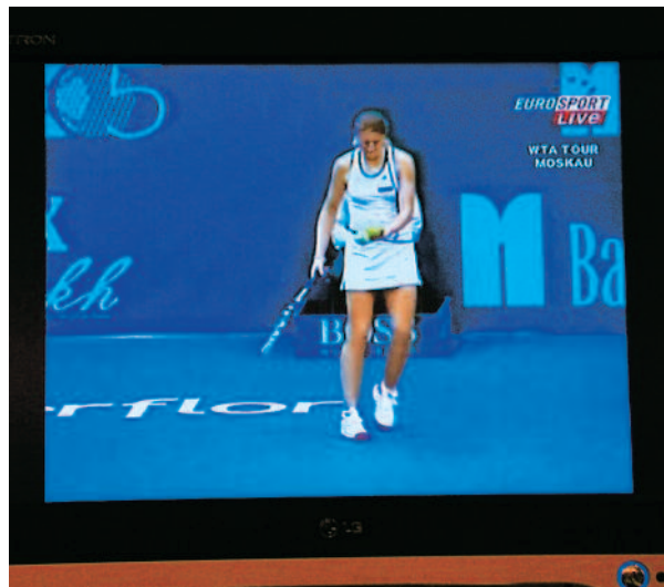
Bild 4: Bei 4:3-Programmen mit voller Zeilenzahl auf Breitbildschirm: Rechts und links vom Bild bleiben schwarze Ränder auf dem 16:9-Bildschirm sichtbar
