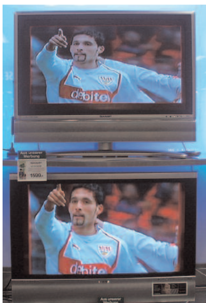
Bild 3: Ein Fernsehbild im 4:3-Format, formatfüllend auf einem 16:9-Bildschirm dargestellt, führt zu einer Stauchung des Bildes (oben). Kompromiss: man schneidet oben und unten ein Teil der Bildinformation ab (unten)
