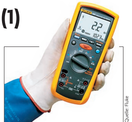
Bild 2: Isolationsmessgerät und Multimeter in einem Gerät
