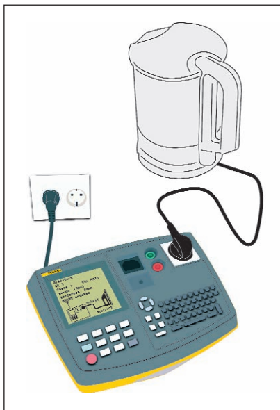
Bild 3: Ohne Umstecken geht es weiter mit der Isolationsmessung
