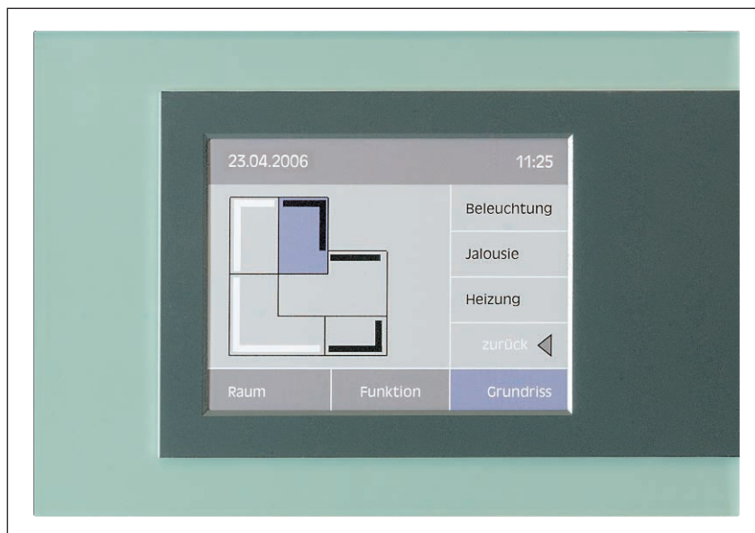
Bild 1: Ein Touch-Panel dient zur Visualisierung und Bedienung des EIB-Automatonsystems
