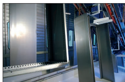
Bild 18: Die Schaltschrankteile werden nach der nanokeramischen Vorbehandlung in nassem Zustand direkt in das Tauchbecken mit der Grundierung geführt
