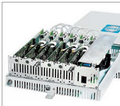
Bild 1: Die digitale Basiseinheit: OM 01, offen. Bis zu sechs Digital-Steckmodule haben hier Platz
