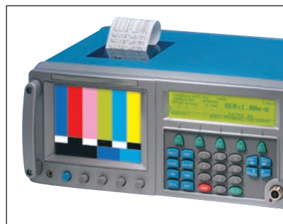
Bild 2: Antennenmessgerät, unentbehrlich bei der Installation von Antennenanlagen
