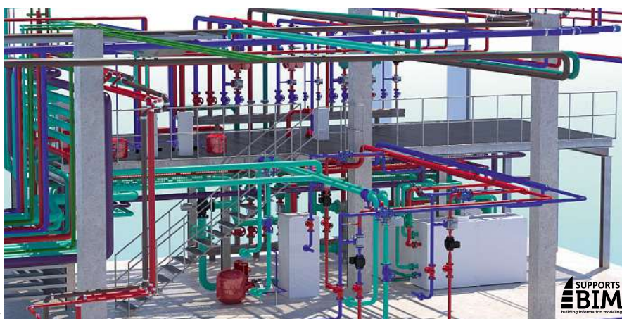
Bild 1: Mithilfe von 3D-Bauteilbibliotheken sind sehr präzise Anlagenansichten möglich, Schnitte und 2D-Ansichten werden automatisch generiert
