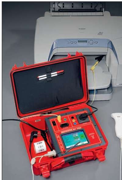
Bild 11: Isolationswiderstandsmessung an einem Bürogerät – Prüfgerät mit Datenerfassung, Speicherkarte, Barcodeleser, Touchscreen
