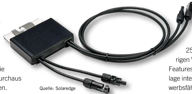
Bild 1: Solche Leistungsoptimierer funktionieren im Prinzip wie ein Modulwechselrichter und führen ein modulweises MPP-Tracking durch
