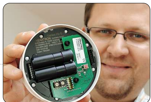
Bild 2: Durch Einstecken eines Funkmoduls wird aus dem konventionellen Rauchwarnmelder ein Funk-Rauchwarnmelder
