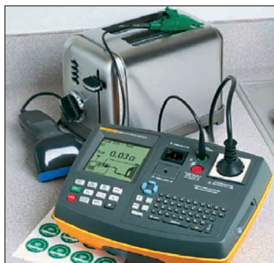
Bild 5: Schutzleiterwiderstandsmessung an einem Arbeitsmittel der Schutzklasse I
