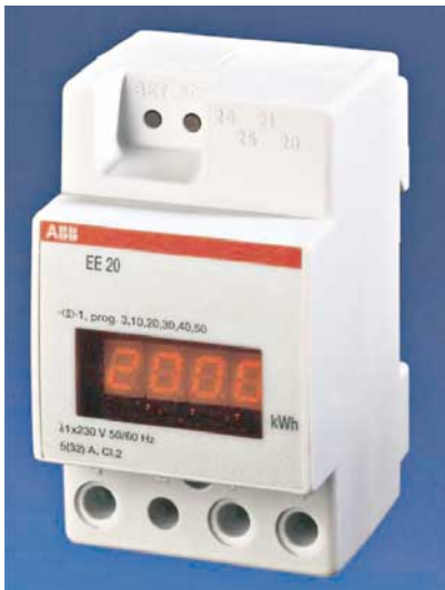
Bild 2: Einphasiger elektronischer kWh-Zähler »Mini-Meter« mit 4-stelliger LED-Anzeige für Direkt- oder 5-A-Wandleranschluss:
