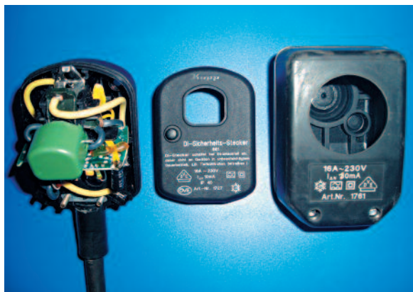
Innenleben einer PRCD-Schutzeinrichtung
